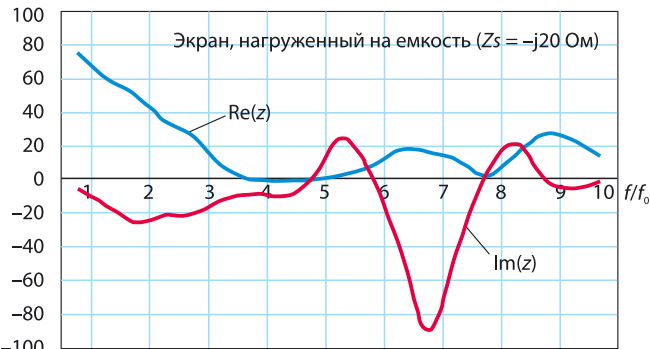
Рис. 6. Зависимость входного импеданса архимедовой спирали от частоты
