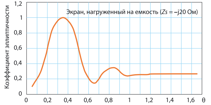
Рис. 7. Зависимость коэффициента эллиптичности архимедовой спирали от угла \theta
