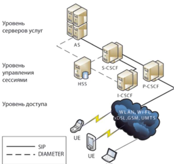
Рис. 1. Упрощенная схема ядра IMS
