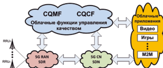
Рис. 5. Виртуализация функций контроля и управления в сети 5G
