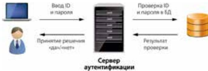
Рис. 4. Упрощенная схема протокола парольной аутентификации
