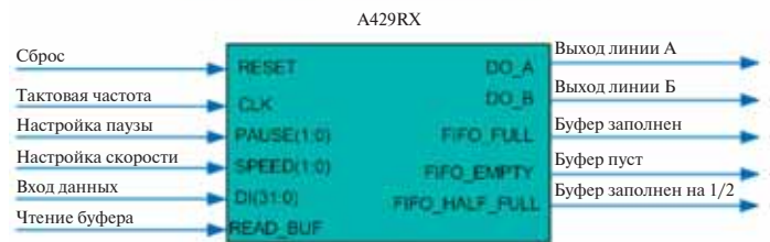
Рис. 3. RTL-схема СФ-блока интерфейса Arinc 429
