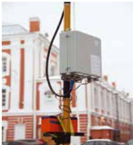
Рис. 2. Стационарное устройство на базе технологии DSRC
