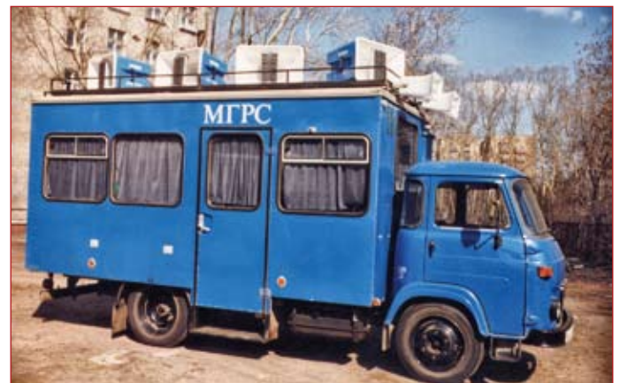
Звукоусилительная станция мощностью 1,0 кВт
